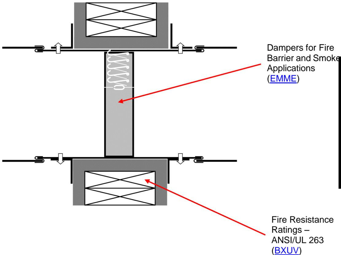
**B. SMOKE AND COMBINATION FIRE-SMOKE DAMPER ILLUSTRATION**
