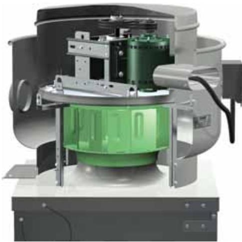
Los extractores centrífugos deberán ser de transmisión por correa. La rueda del ventilador debe ser inclinada hacia atrás, construida de acero y con acabado antiadherente similar al Teflon® según lo fabricado por DuPont™ e incluirá un cono de rueda cuidadosamente emparejado en el cono de entrada para precisar tolerancias de ejecución. Las ruedas deberán ser equilibradas estática y dinámicamente.
