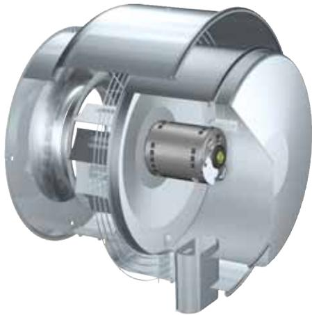
Los extractores centrífugos con descarga hacia arriba deberán ser de transmisión directa. La rueda del ventilador debe ser inclinada hacia atrás, construida de aluminio e incluirá un cono de rueda cuidadosamente emparejado en el cono de entrada para precisar tolerancias de ejecución. Las ruedas deberán ser equilibradas estática y dinámicamente. La cubierta del ventilador deberá ser construida de aluminio rígido con una estructura de soporte interno.
