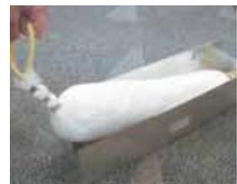
**Trampa de Grasa con Material Absorbente** — Igual que el anterior con un material absorbente para retener residuos de grasa facilitar su eliminación.
